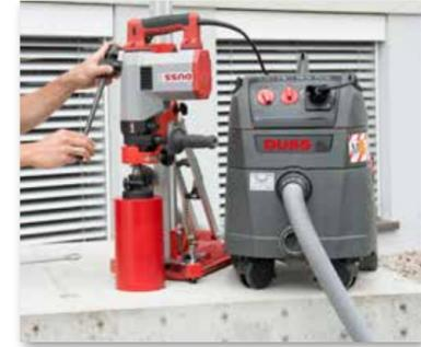
Ständergeführte Trockenbohrung in armierten Beton. Die optionale Trockenabsaugung TBS gewährleistet den effizienten Abtransport des Bohrmehls bei Bohrungen mit einem Bohrstand.
